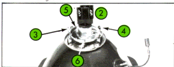
Fig. 7 Projecteurs « CIBIE » 2 - Connecteur 3 - 4 - Ressorts de maintien 5 - Collerette d'ampoule 6 - Ergot de positionnement
